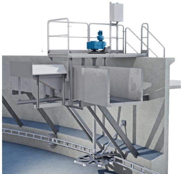
Il raschiatore può essere dotato di una lama raschiante superficiale periferica supportata dal braccio di fondo. La lama di superficie raccoglie la schiuma superficiale e la convoglia nello scum-box fissato alla parete di cemento. Il fango viene allontanato dallo scum-box tramite tubazioni che attraversano la parete di cemento della vasca.
