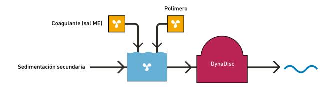
Ejemplo de un diagrama de flujo de Nordic® ZeroP
