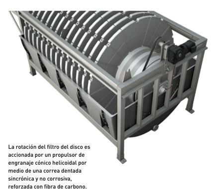
Cuando el nivel de agua dentro de los discos filtrantes aumenta hasta un punto predefinido, el rotor del filtro empieza a girar y se pone en marcha el contralavado de la tela filtrante. Las boquillas pulverizadoras de contralavado de alta presión separan los sólidos en suspensión acumulados y los conducen hacia el canal de rechazo del interior del filtro. Los sólidos en suspensión se descargan por gravedad.
